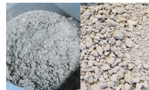
焼却灰（左）と飛灰処理汚泥*（右）
