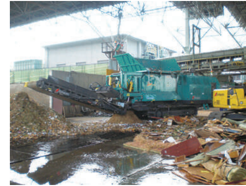
木材粗破碎機 (丸太や生木などを破碎するための機械)
