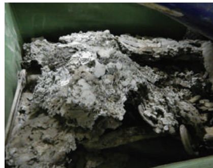
アルミニウム等の金属が溶けて固まったもの (渋谷清掃工場)
