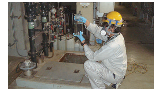
排水採取の様子（板橋清掃工場）
