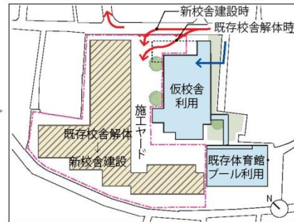
【第2ステップ】 既存校舎解体、新校舎建設(Ⅰ期工事)
