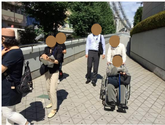
写真 3 長くて急で、手すりの位置が高いスロープ
