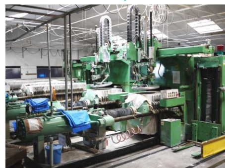
リサイクルした粘土を混ぜ合わせて、坏土（はいど:焼く前の土）を作ります
