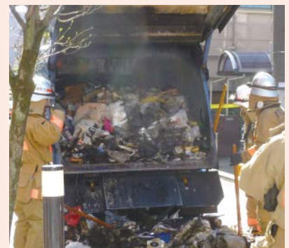
▲ガスが内部に残っていたスプレー缶が原因と思われる車両火災
